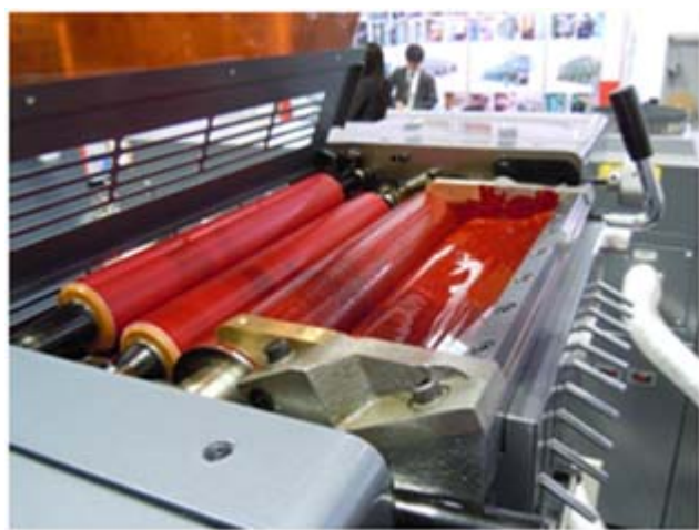
Encrier à réglage par leviers et preneur motorisé
