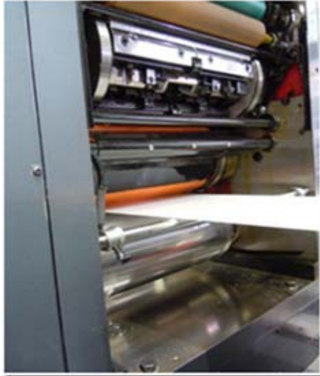
Cylindres de plaque, blanchet et de marge
