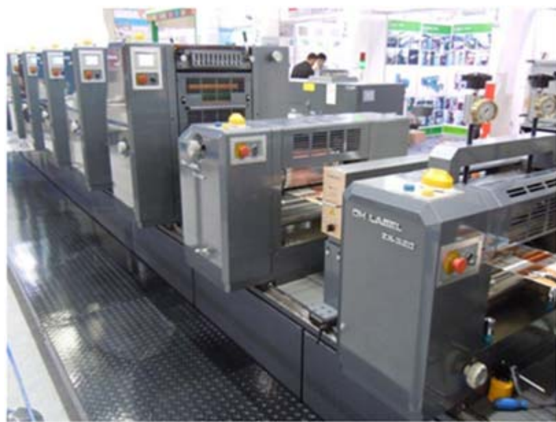
Poste de vernissage et de découpe magnétique avec Hydra-Jack
