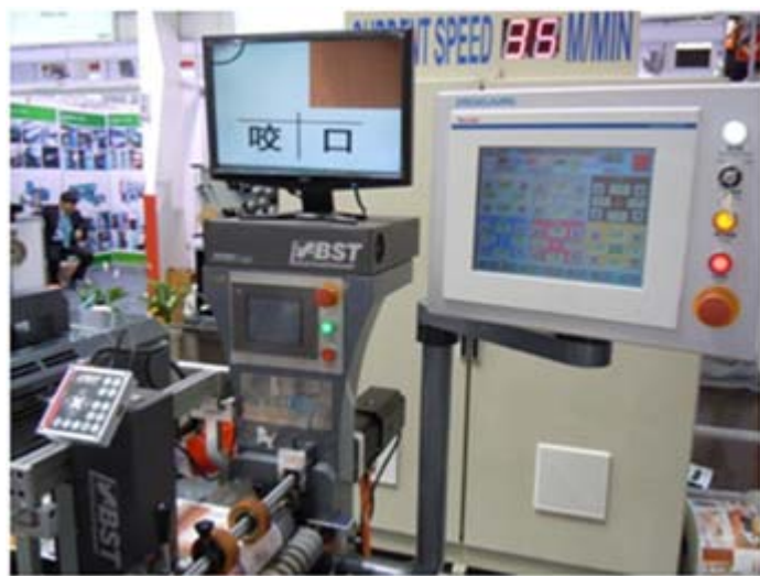
Pupitre à écran tactile Bosch-Rexroth et caméra de contrôle BST
