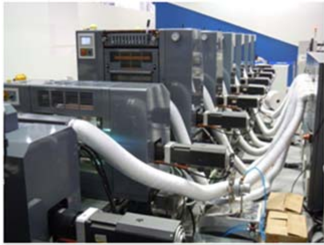
Entrainement « full-servo » Bosch-Rexroth
